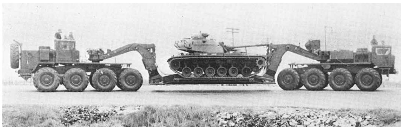
v.l.n.r.: XM377, XM2 met M48 en XM376. Onder dezelfde combinatie. Alleen daar is geen reservewiel geplaatst en zijn de cabines open. Hij is beladen met een experimentele T95 tank.
