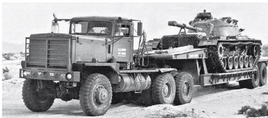
XM523E1 met een M524E1 oplegger. Lading is een M48A3.
